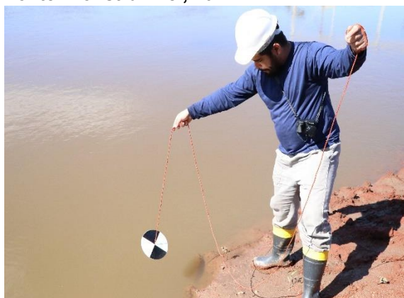
Figura 9.11: Aferição da profundidade com disco de Secchi. Fonte: Construnível, 2021.
