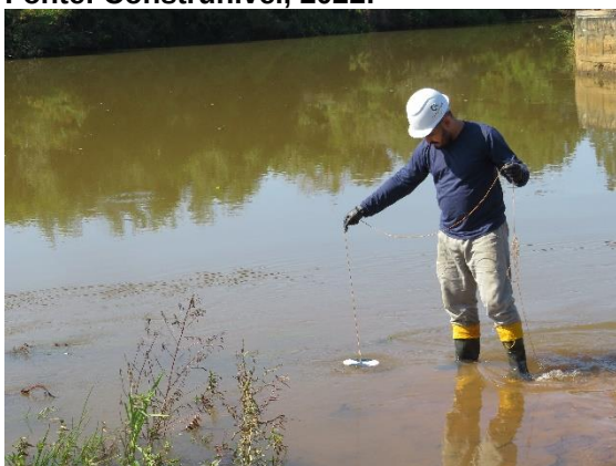
Figura 9.3: Aferição da profundidade com disco de Secchi. Fonte: Construnível, 2022.
