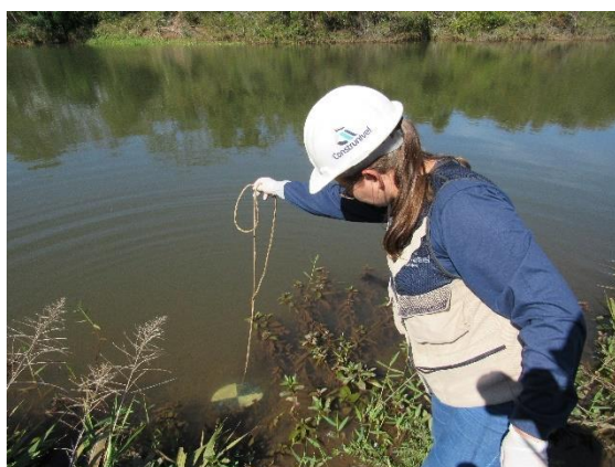
Figura 9.1: Aferição de transparência com Disco de Secchi – 1ª Relatório. Fonte: Construnível, 2020.
