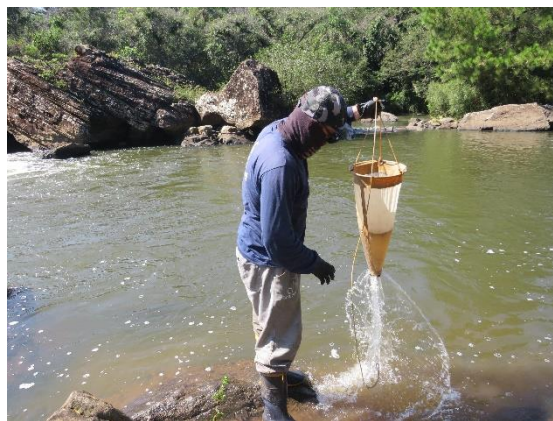
Figura 9.6: Coleta com rede Fitoplâncton Fonte: Construnível, 2022.
