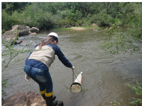
Figura 9.9: Coleta com rede de fitoplâncton – 2ª Relatório. Fonte: Construnível, 2021.
